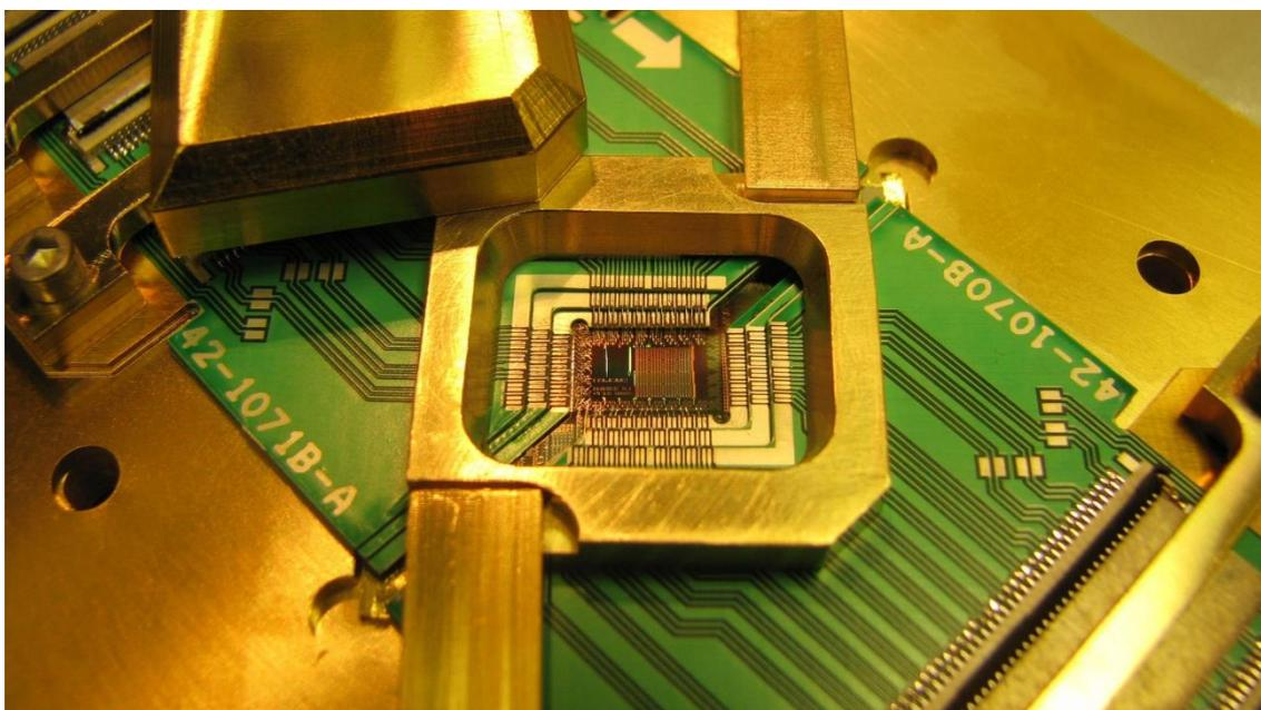
Figura 4. Procesador Rainier de 128 cúbits — © D-Wave Systems
