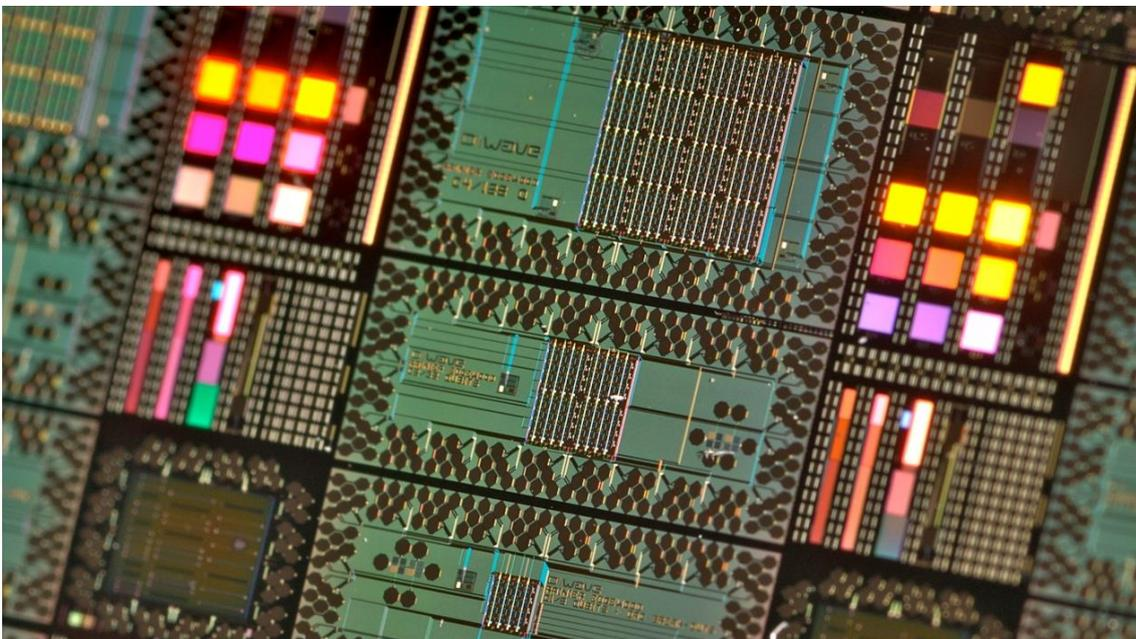
Figura 1. Lámina y procesadores para el temple cuántico — © D-Wave Systems
